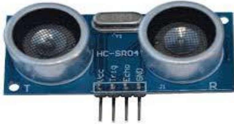
شكل (5-2) الحساس فوق الصوتي (HC-SR04)
