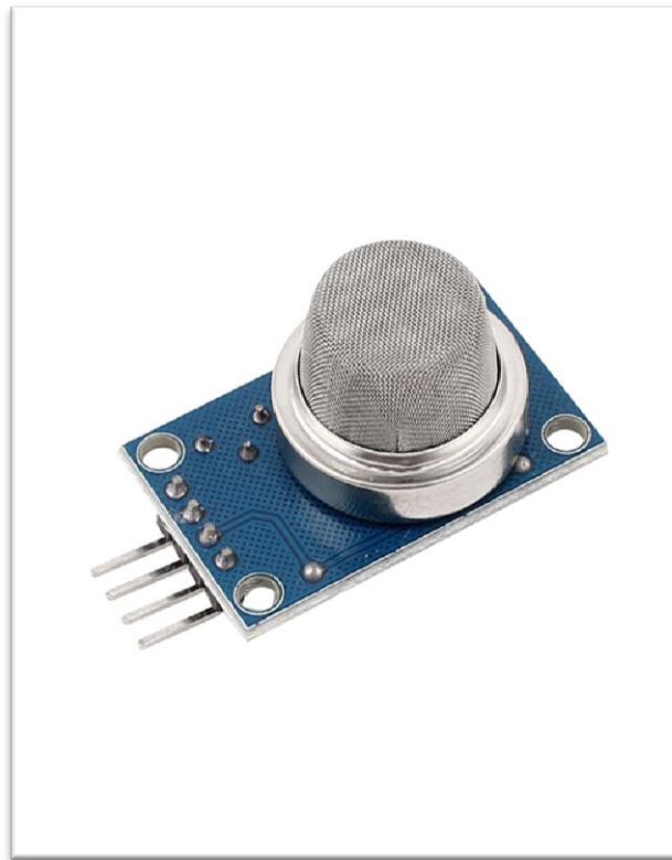
شكل (5-6) يوضح شكل حساس الغاز
