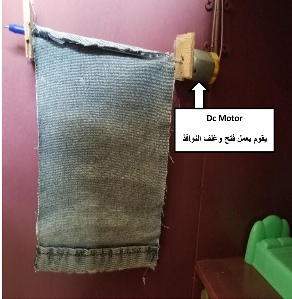
شكل (5-8) يبين لنا عمل Dc Motor في المشروع
