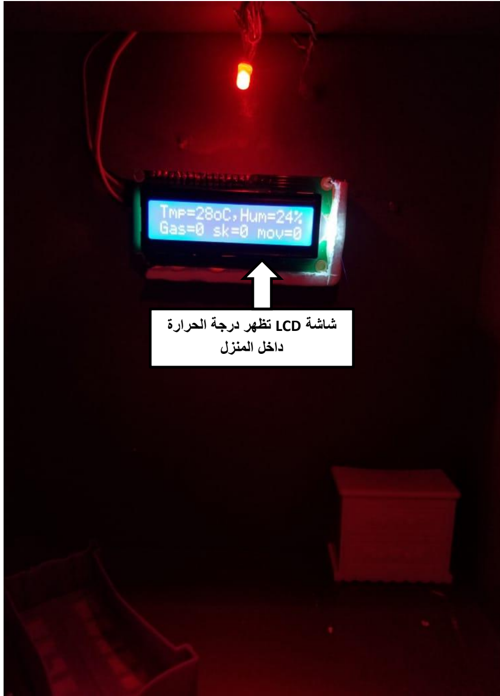
شكل(5-12) يوضح لنا تركيب شاشة LCD في المشروع
